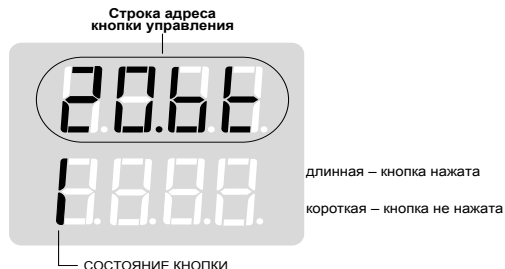
Рисунок 8 – Пример табло показывающего прибора при просмотре состояния кнопки
